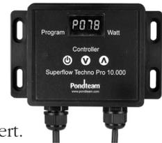
**HINWEIS!** Wenn der Controller nicht mehr auf Schalterbetätigungen reagiert, ist der Netzstecker abzuziehen und nach ein bis zwei Minuten Wartezeit wieder anzuschließen, damit der Controller erneut hochfahren wird.
